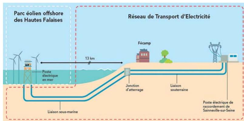
La liaison électrique de 50 km comprendra 18 km de liaison sous-marine, entre le parc éolien et le point d'atterrage situé au niveau du port de Fécamp, et 32 km de ligne électrique souterraine jusqu'au poste de Sainneville (près du Havre). RTE renforcera également le réseau existant avec la création d'une nouvelle ligne souterraine 225 kV entre les postes de Sainneville et Pont-Sept sur une distance de 12 km.
